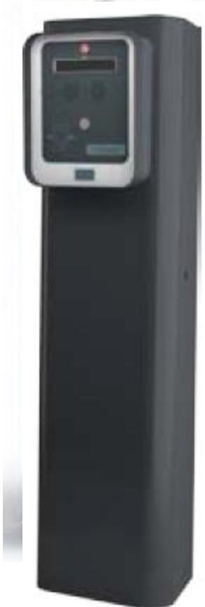
Izlazni terminal funkcioniра u podatkovnoj mreži sa ostalim komponentama sustava, pri čemu je potrebno provesti žice za napajanje, kontrolu rampe te podatkovnu liniju između ostalih komponenti sustava.. Terminal mora pružati mogućnost sveobuhvatnog upravljanja ulazom u automatizirano parkiralište, kao i mogućnost kombiniranja s drugim terminalima za automatizaciju najviše 8 ulaza i izlaza.
